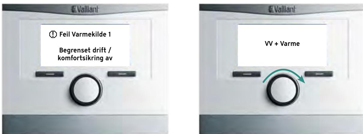
For å aktivere vanlig drift og temperaturer (kun med strøm) vris hjulet mot høyre til det står varme på nederste linje, NB! Man trenger ikke å trykke for å bekrefte valget. Har man varmepumpe med integrert varmtvannsbereder vris røttet til varme og varmtvann. Varmepumpen vil nå fungere som normalt, men uten kompressordrift.
